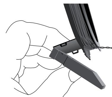
2. Poussez la languette dans la fente ouverte à la base du support. Appuyez jusqu'à ce que la languette se place dans son logement et fasse entendre un déclique.
