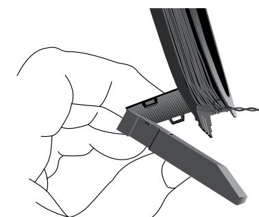
2. Duw de tab in de open sleuf in de basis van de stander. Druk totdat de tab vastklikt.
